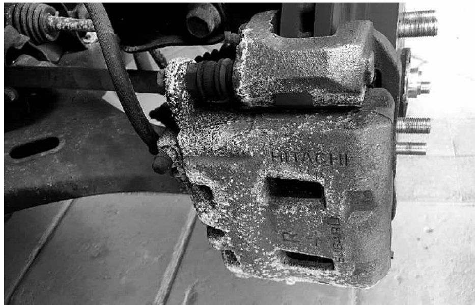
车辆底盘有明显的腐蚀痕迹 本组图片 B24
