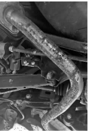
车辆底盘有明显的腐蚀痕迹 本组图片 B24
